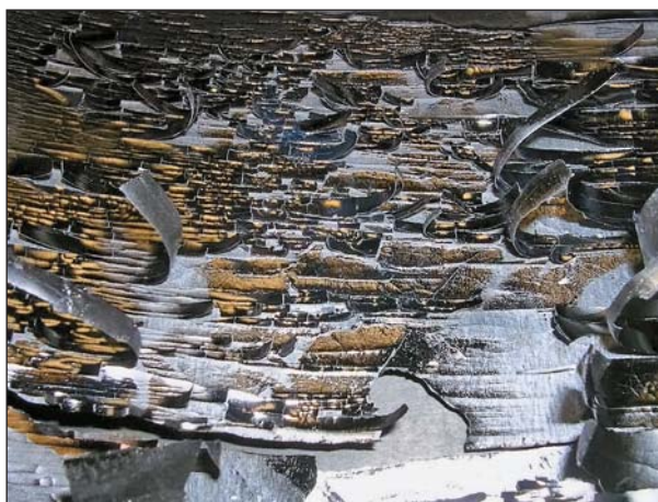
Лист вольфрама после многократного облучения плазменным потоком в выходном узле ловушки ГОЛ-3.
